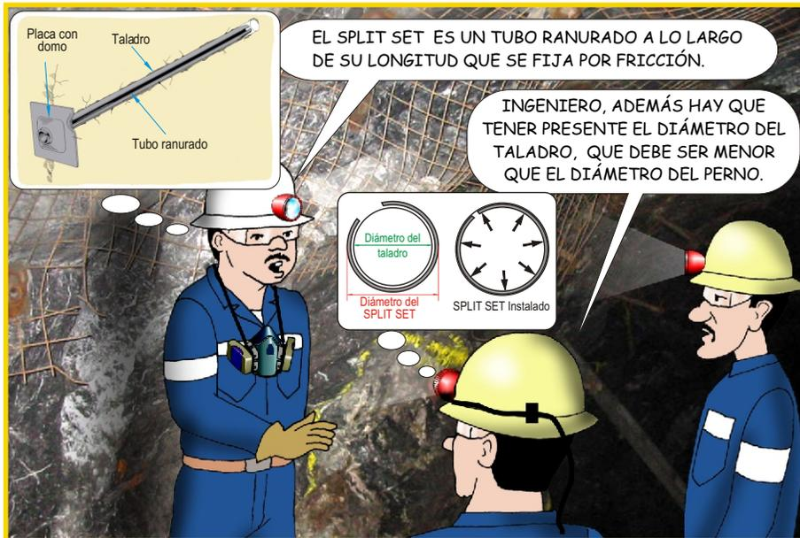
EL SPLIT SET SE EMPLEA EN ROCAS REGULARES A MALAS DE LABORES TEMPORALES. SU INSTALACIÓN ES SIMPLE, MEDIANTE EL USO DE UN ADAPTADOR (CULATÍN) Y UNA PERFORADORA.
