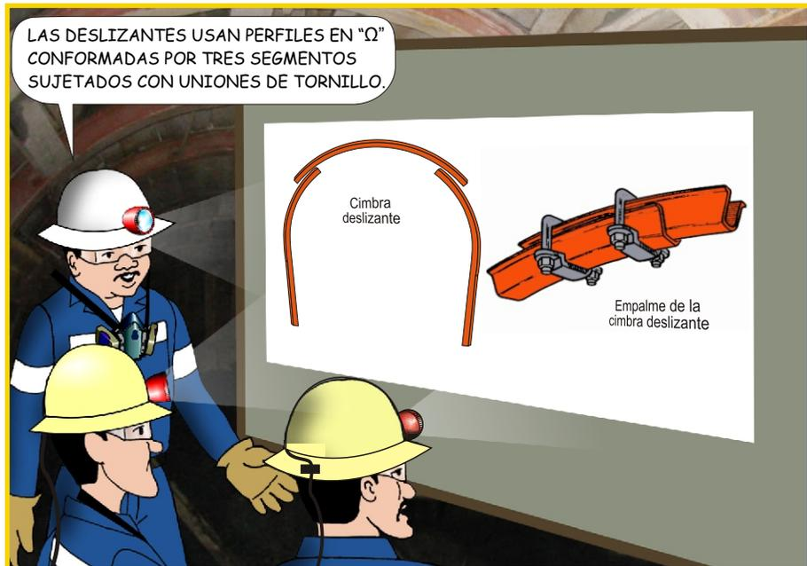
LA FORMA DE LA CIMBRA ESTARÁ EN FUNCIÓN DE LA FORMA DE LA SECCIÓN DE LA EXCAVACIÓN.
