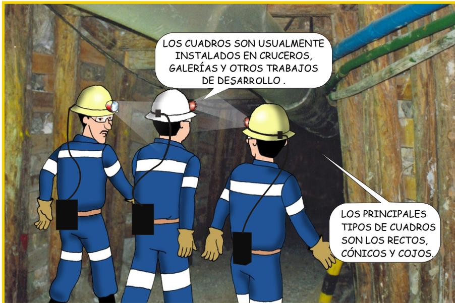
LOS CUADROS SON INSTALADOS EN ZONAS DE ROCA FRACTURADA A INTENSAMENTE FRACTURADA Y TAMBIÉN EN CONDICIONES DE ALTOS ESFUERZOS O PRESIONES.
