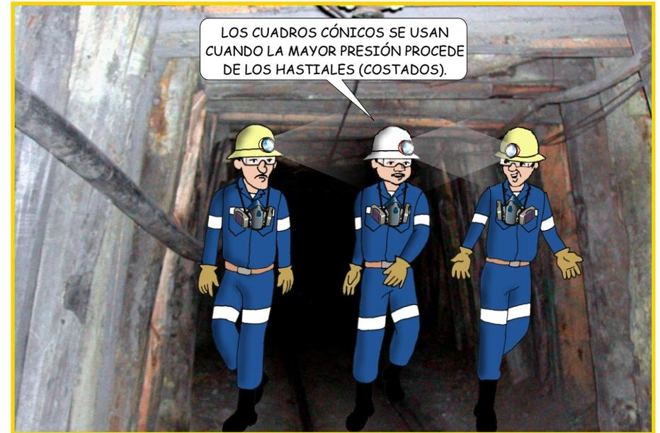
UN ASPECTO MUY IMPORTANTE ES QUE LOS CUADROS ESTÉN EN CONTACTO CON LA SUPERFICIE A SOPORTAR Y ESTO SE CONSIGUE TOPEANDO EL TECHO Y LOS COSTADOS DE LA EXCAVACIÓN.
