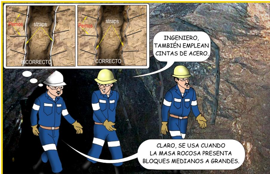
LA RIGIDEZ DE LA CINTA (STRAP) ES UN ASPECTO CRÍTICO, ESPECIALMENTE EN EXCAVACIONES IRREGULARES. LOS STRAPS DEBEN ESTAR MOLDEADOS A LA SUPERFICIE ROCOSA. SE INSTALAN MEDIANTE EL EMPLEO DE PERNOS DE ROCA.
