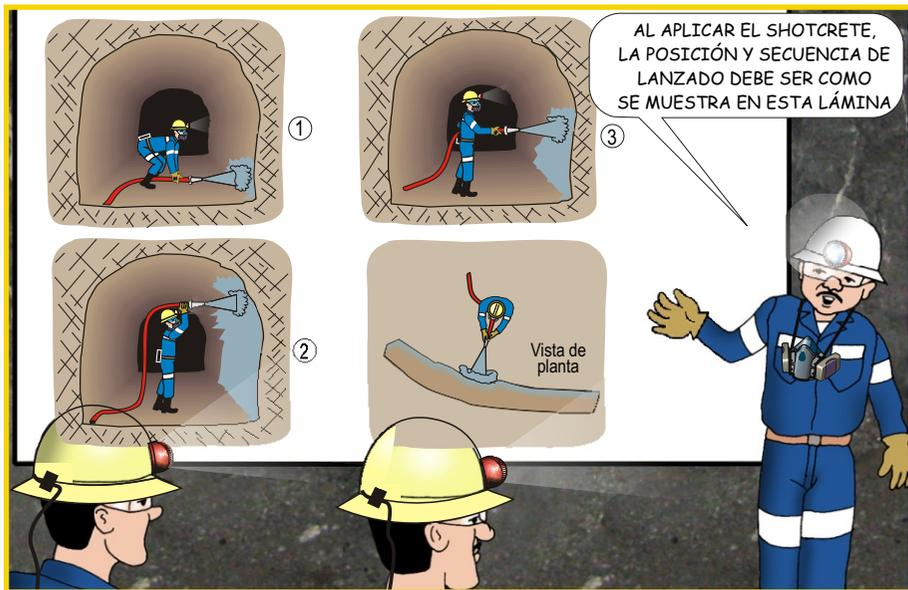
AL APLICAR EL SHOTCRETE, LA POSICIÓN Y SECUENCIA DE LANZADO DEBE SER COMO SE MUESTRA EN ESTA LÁMINA
