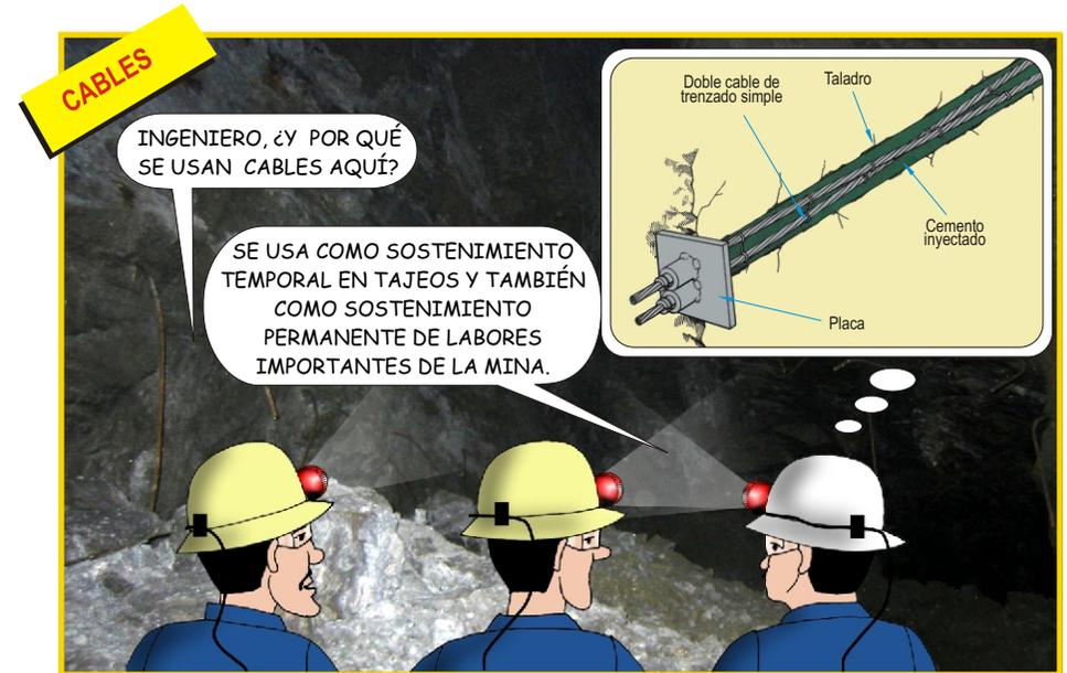
LOS CABLES SON ELEMENTOS DE REFORZAMIENTO HECHOS NORMALMENTE DE ALAMBRE DE ACERO TRENZADO, QUE SON FIJADOS CON CEMENTO DENTRO DEL TALADRO. LA LONGITUD DE LOS CABLES VARÍA DE 5 A 30 METROS APROXIMADAMENTE.
