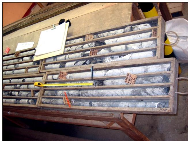
Figura 3.2 Testigos de perforación diamantina.
