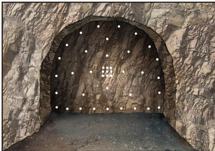
*Figura 3.22 Diseño de malla de perforación.*
